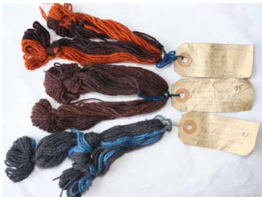
Fig. 6: Sandelbrun-koksgrå. Den øverste rødbrune er farvet med 5 gr. sandel og 600 mg sumak. Nr. 35 er med 6 gr. sandel og nr. 28 med 3 gr. sandel. Halvdelen af hver dunt er overfarvet med 300 mg galæble tilsat vitriol, henholdsvis 275 mg, 500 mg og 200 mg. Den øverste har desuden fået 275 mg vinsten. Ved nr. 35 giver overfarvningen med galæble ingen nævneværdig forskel. VejleMuseerne, 916x102A.
